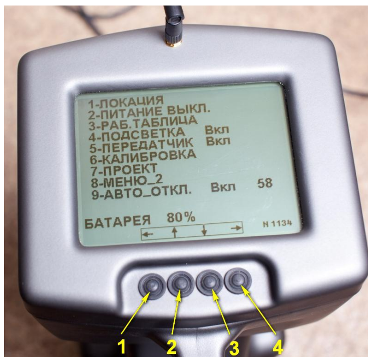
Рис. Назначение кнопок на приемнике.
